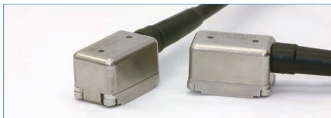
Среднезахватный преобразователь на фазированной решетке — (GEIT Global PN 1314600) • 5 МГц, активная длина — 24 мм (0,945 дюйма) с 6-ю или 10-ю элементами на выбор. • 23 или 27 виртуальных преобразователей, покрывающих до 20 мм (0,79 дюйма). • Преимущества: среднее покрытие с отличной околповерхностной разрешающей способностью и плоской амплитудно-частотной характеристикой. • Малая площадь опорной поверхности улучшает акустический контакт на изогнутых поверхностях и увеличивает разрешающую способность в поперечном направлении.
