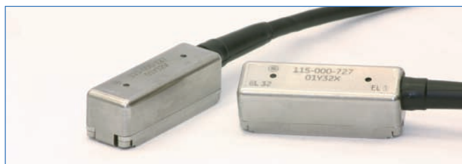
Широкозахватный преобразователь на фазированной решетке — (GEIT Global PN 1314599) • 5 МГц, активная длина — 48 мм (1,890 дюйма) с 3-х или 5-элементной апертурой на выбор. • 28 или 30 виртуальных преобразователей, покрывающих до 44 мм (1,73 дюйма). • Преимущества: широкое покрытие с отличной околповерхностной разрешающей способностью и плоской акустической характеристикой.
